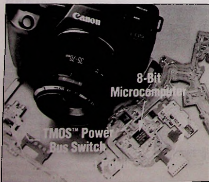
Fig. 8. Het automatische scherpstellen bij de digitale motorsturing geschiedt met variabele snelheid: met snelle start en langzame stop met zeer accurate scherpstelling.
